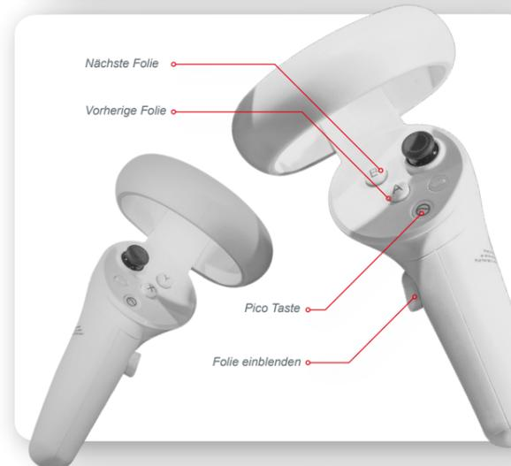
6. Drücken Sie nun die „Pico Taste“ (die Vertiefung auf dem Controller) und wählen Sie von den angezeigten Optionen „Screencast“ aus.
